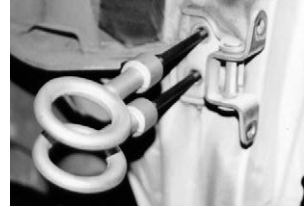
●ドアヒンジを利用した取り付け
