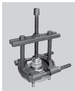
●FF車のフロントハブインナーレースの抜き取り
