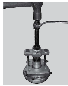
●ハンマーで「叩く」レンチで「回す」の繰り返し作業で
