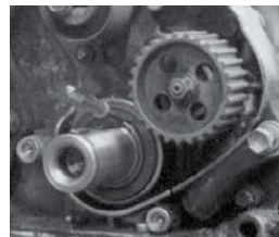
●クランクシャフトオイルシール抜取り
