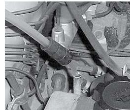
●レベルゲージ口を利用して吸油します。
