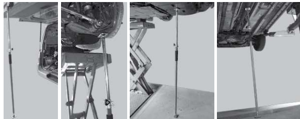
●ダンパー交換 ●脱着サポート ●ゴムパッドを利用してアンダーカバーやマフラーの取り外しの際に
