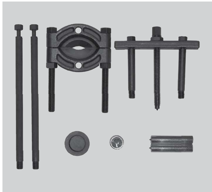
●別売品:ヨークボルトを利用してリヤシャフトベアリングの抜き取り(カラーはグラインダー・タガネ等で切断して取外してから使用してください。)
