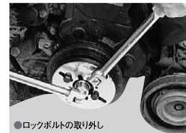
●ロックボルトの取り外し
