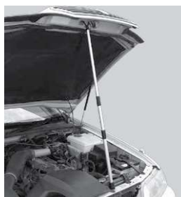
●ボンネットダンパー交換時の閉まり止めとして。
