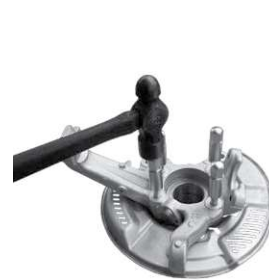
●ベアリング抜き取り例
