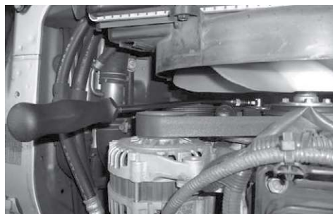
●狭いエンジンルーム内でも先端部の湾曲により、通常のストレートメガネレンチでは不可能な部位にも到達できます。
