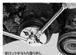
●ロックボルトの取り外し
