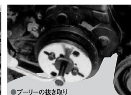
●プーリーの抜き取り
