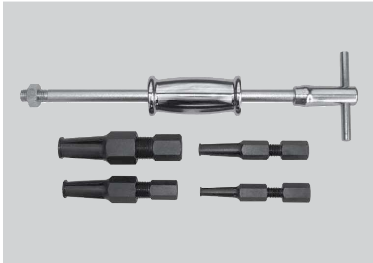
※ベアリング内で爪を広げてからスライドハンマーショックによりベアリングを抜いてください。
