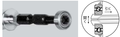
※ベアリング内で爪を広げてからスライドハンマーショックによりベアリングを抜いてください。
