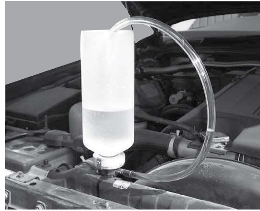
●タンクは1リットルと大容量。残った液はホースをタンクより下にする事で排出されます。
